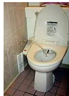
Toilettes-bidet-séchoir Le tuyau de la douchette sort après que la chasse d'eau ait été tirée et se rétracte par la suite. Le séchoir à l'arrière se met en marche à la fin du cycle de lavage.
