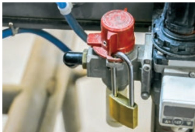
Exemple de cadenassage d'une soupape.
