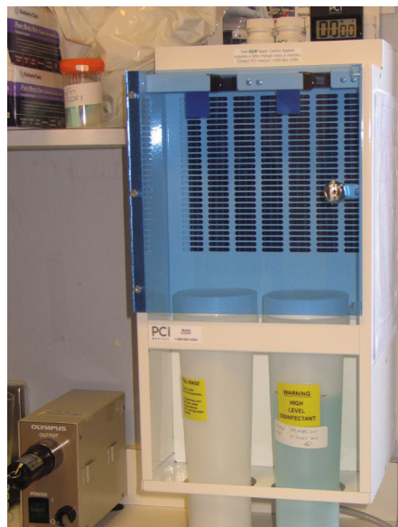
Exemple de station de trempage avec capture des vapeurs sur filtre HEPA
