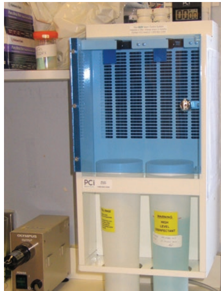
Exemple de station de trempage avec capture des vapeurs sur filtre HEPA
