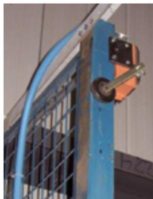
*En conservant la porte ouverte, le mécanicien travaille debout devant le chariot basculé. Toute action sur le bouton de mise en marche est inopérante.*
