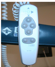
Manette Touches : monter, descendre, gauche, droite, station charge, programmation
