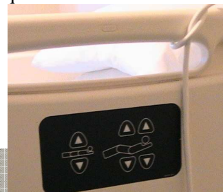
Manette de commande intégrée Sur la ridelle du haut du lit de chaque côté
