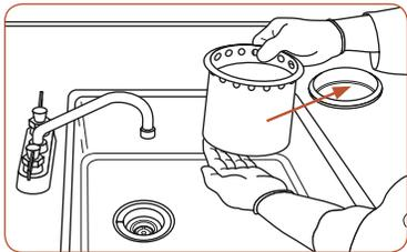
Comptoir muni d'une ouverture pour y déposer un récipient pour récupérer le formol et les pièces anatomiques échappées.
